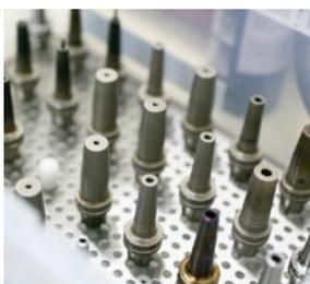
3D Design Labでは、ドイツ・レダース社のマシンを2台導入。R0.25mmという極小の先端径で日本国内のセンターでは一番細いドリルで加工している。
