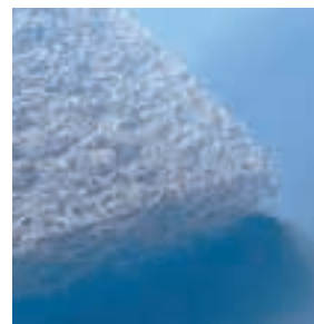
マットレスパッドの中のエアウィーヴ素材は、極細繊維状樹脂が三次元に絡み合っていてできている。
