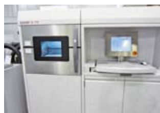
レーザー技術を利用した3Dプリント。金属の粉末にデータ通りにレーザーでなぞると・・・。
